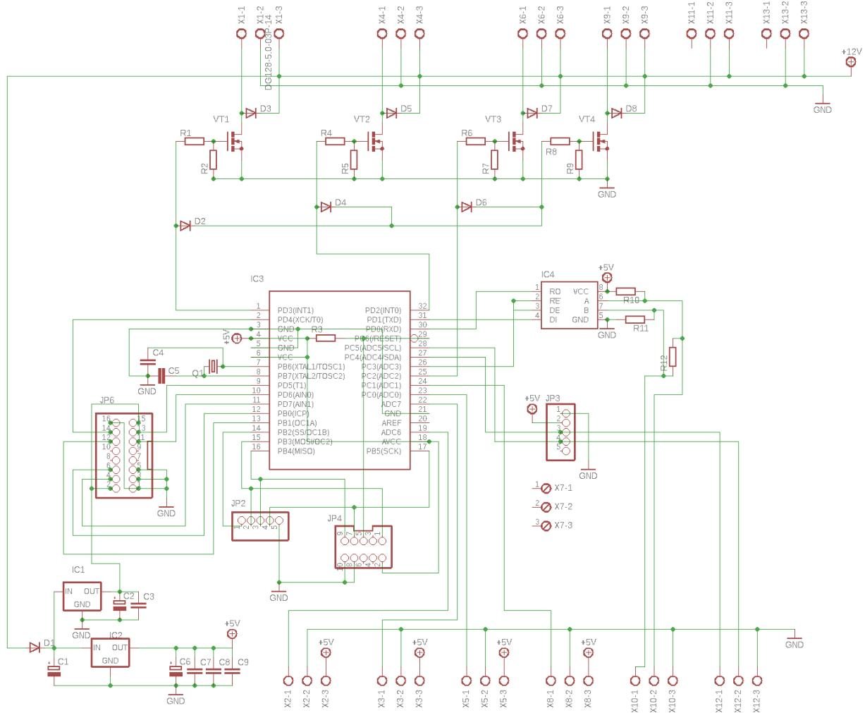
К разъему JP1 подключен индикатор МЭЛТ MT-16S2D-2YLG. Разъем JP2 предназначен для подключения клавиатуры. Разъемы JP3 и X7 предназначены для установки модуля часов реального времени (опционально).
