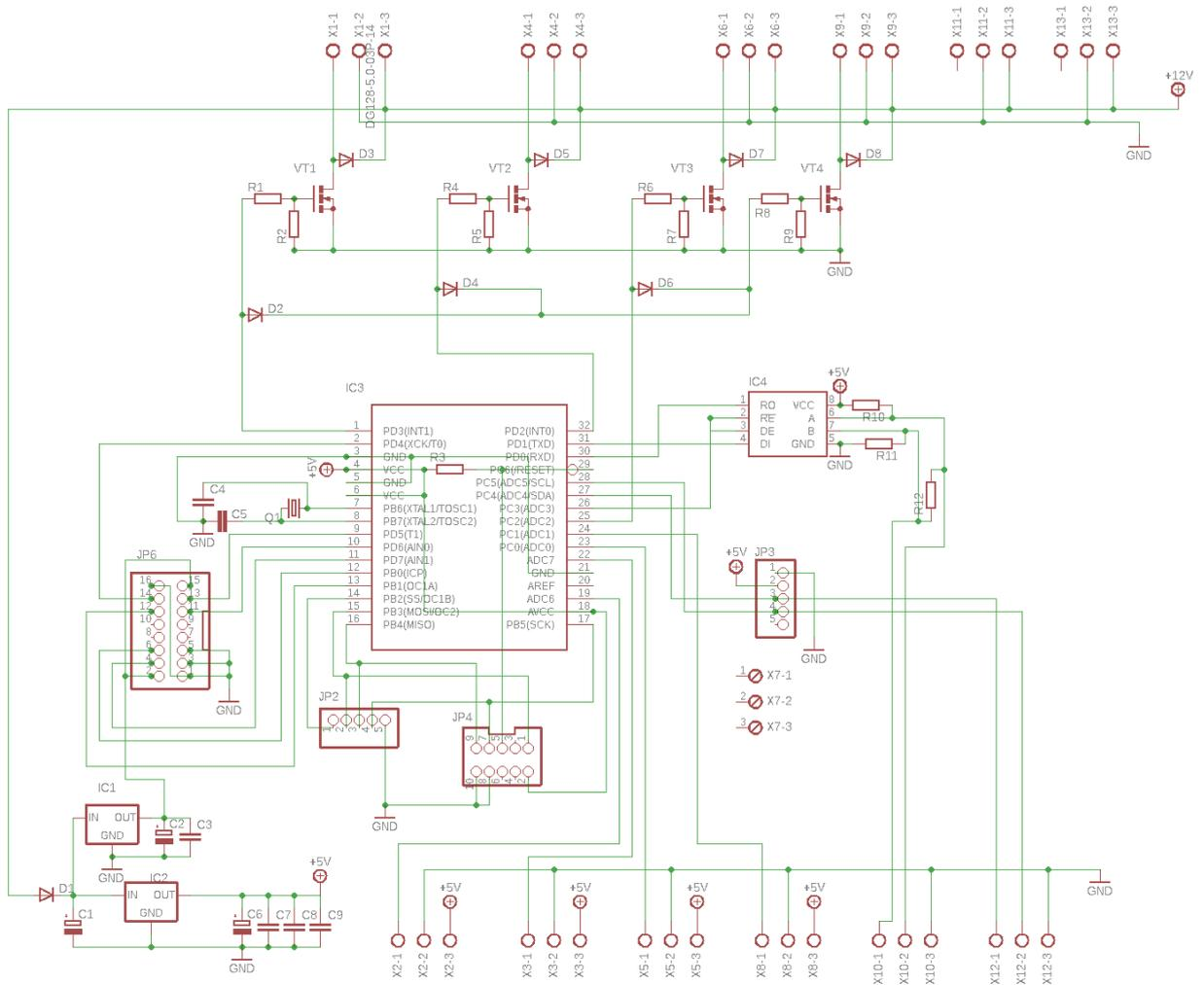
К разъему JP1 подключен индикатор МЭЛТ МТ-16S2D-2YLG. Разъем JP2 предназначен для подключения клавиатуры. Разъемы JP3 и X7 предназначены для установки модуля часов реального времени (опционально).
